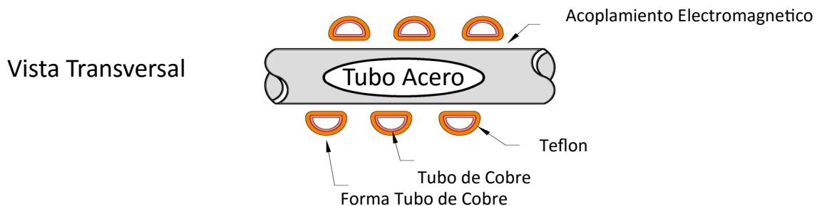
Las bobinas son mecánicamente formadas con rodillos de presión y radios específicos para lograr una alta precisión en el formado circular del tubo de cobre permitiendo que su forma aplanada al interior de la bobina resulte en un mayor acoplamiento electromagnético entre la misma bobina y el tubo de acero que se está fabricando. Este mayor acoplamiento electromagnético permite que el soldador sea más eficiente resultando en un ahorro de energía o incremento la potencia aplicada.
